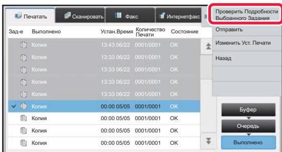
Коснитесь задания, параметры которого нужно проверить, затем на панели действий коснитесь пункта [Проверить Подробности Выбранного Задания].
