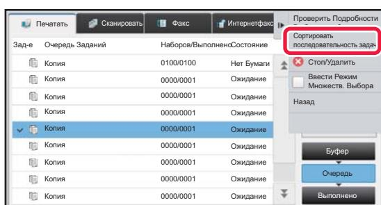
**Коснитесь задания, приоритет которого нужно изменить, затем на панели действий коснитесь пункта [Сортировать последовательность задач].**
